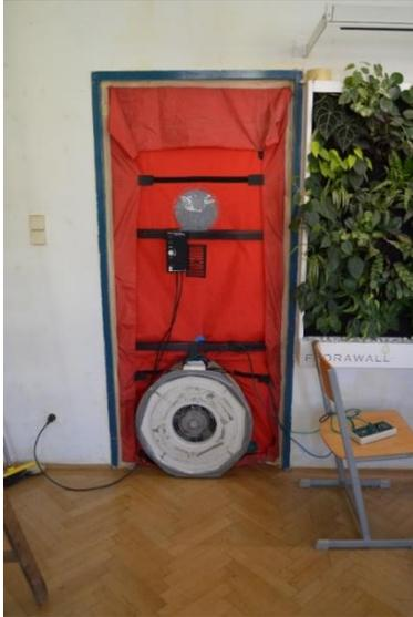
Abbildung 12: Ventilator des Blower Door-Tests im Türstock der begrünten Klasse.
