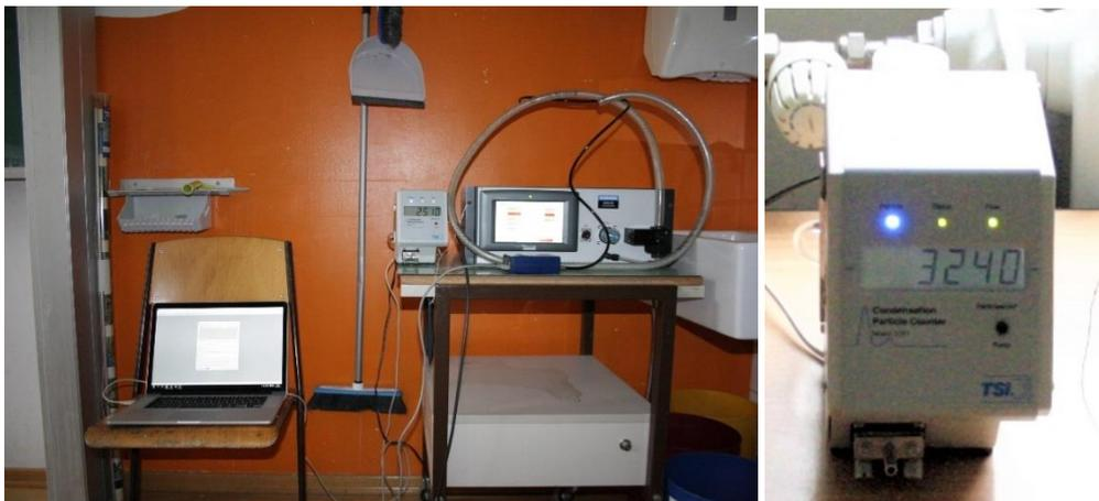
Abbildung 11: Aufbau Messinstrumente: Links Fidas<sup>®</sup> 200, rechts Kondensationspartikelzähler
