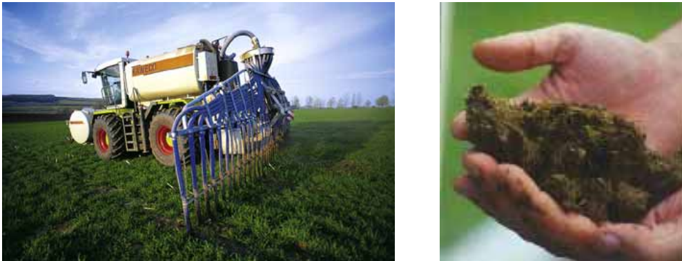
Abbildung 13: Ausbringung des ausgegorenen Gärsubstrates; Bild links: flüssig mittels Schleppschlauchtechnik [Claas (2003)]; Bild rechts: ausgepresster Faulschlamm [Graf (2003)].
