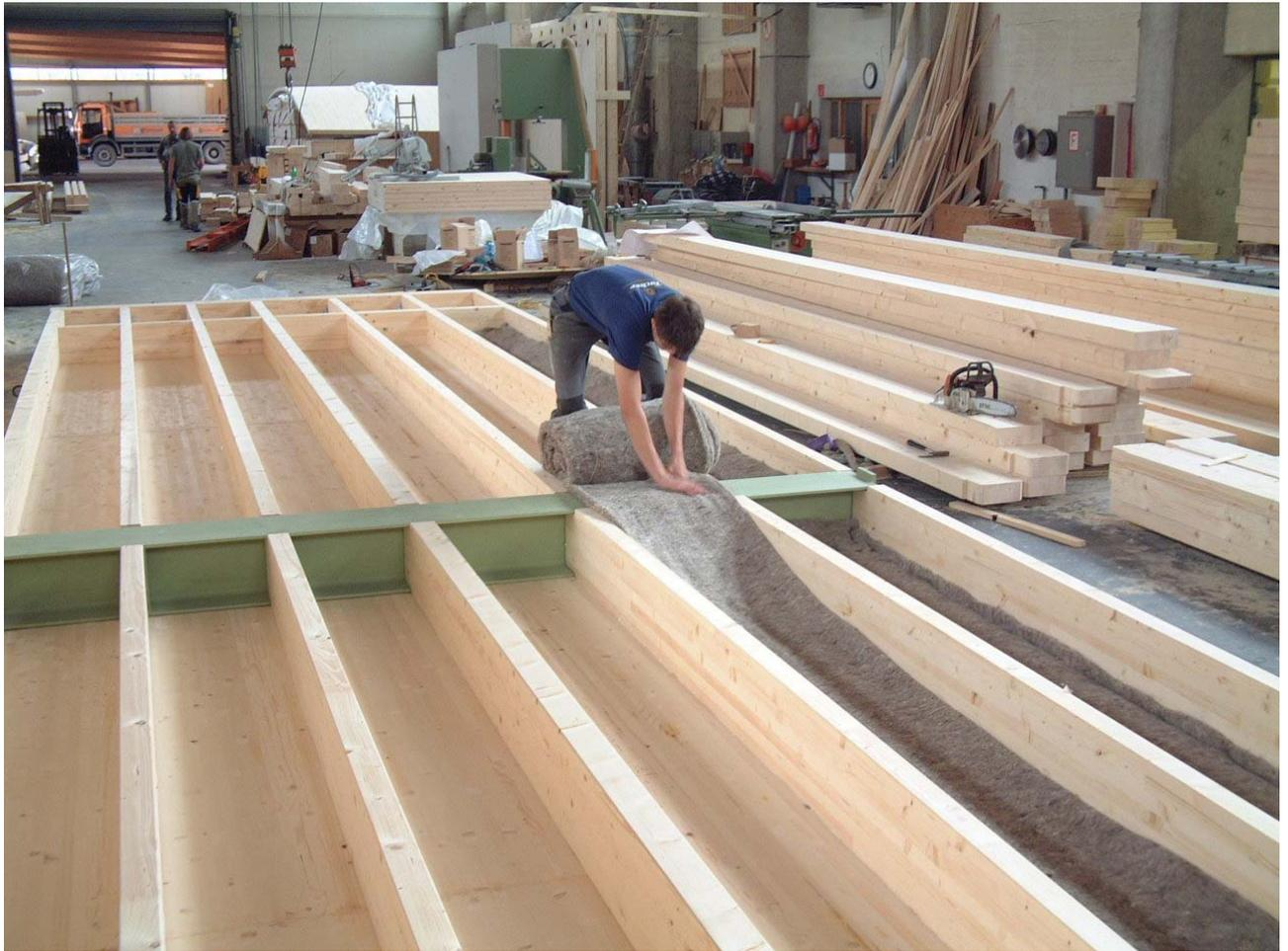
**Abbildung 60: Vorfertigung Hohlkastenelement**
