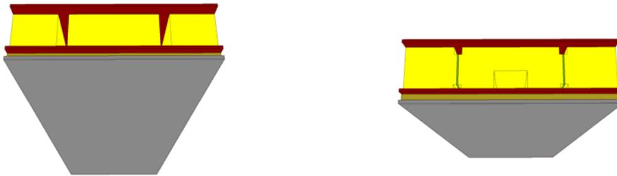
**Abbildung 30: Außenwände mit massivem Holzsteher 70/300 bzw. mit Stegträger**
