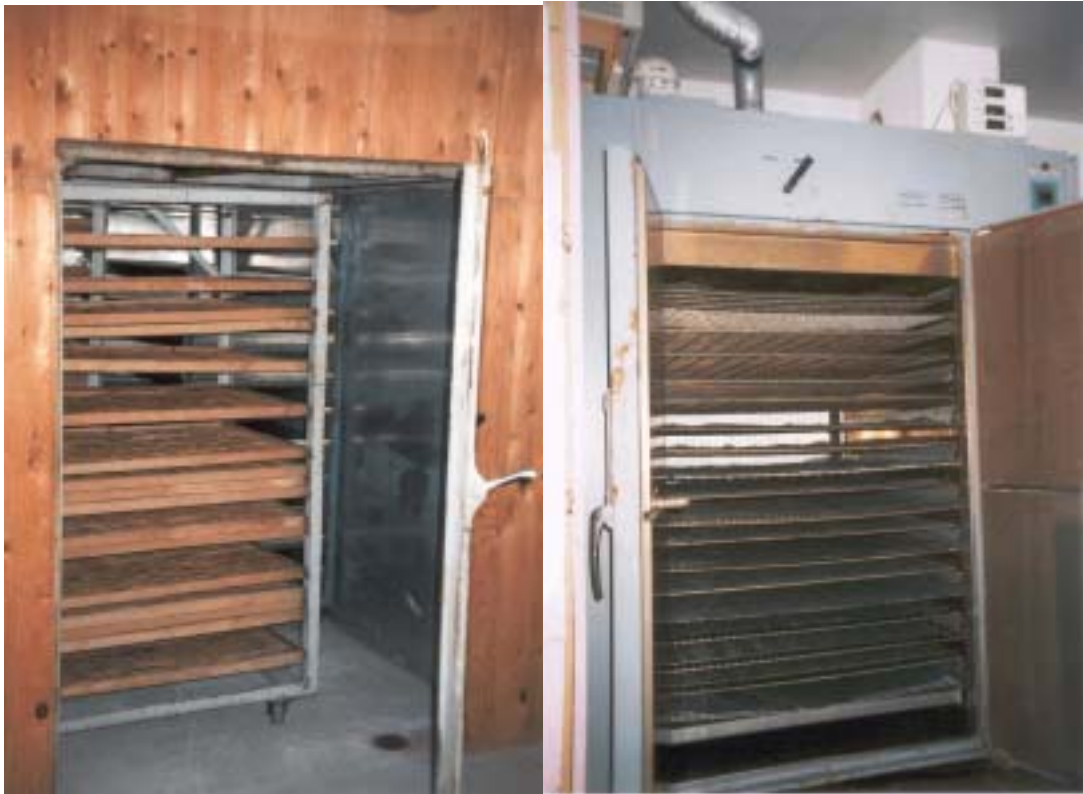
Abbildung 22: Ansichten eines begehbaren Umluft-Trockenraumes (links) mit fahrbarem Hordengestell im Vergleich zu einem Trockenschrank (rechts)
