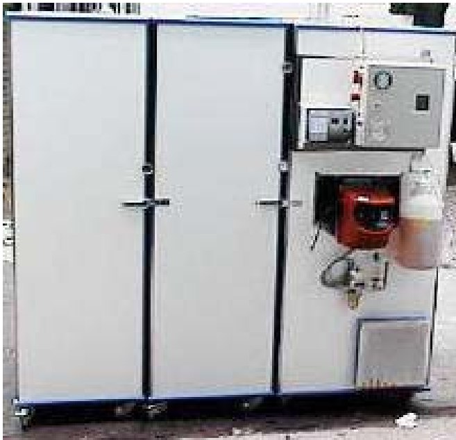
Abbildung 3: Kasten-Umlufttrockner für ca. 200 kg Rohware auf 88 Horden ( 95,5 x 60 cm) (Quelle: www.untroma.de )
