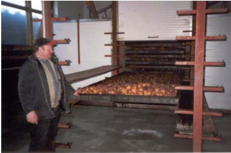
Abbildung 27: Nebeneinander angeordnete Containertrockner für Birnen-Ganzfrüchte mit einer am Rollgestell herausgezogenen Horde
