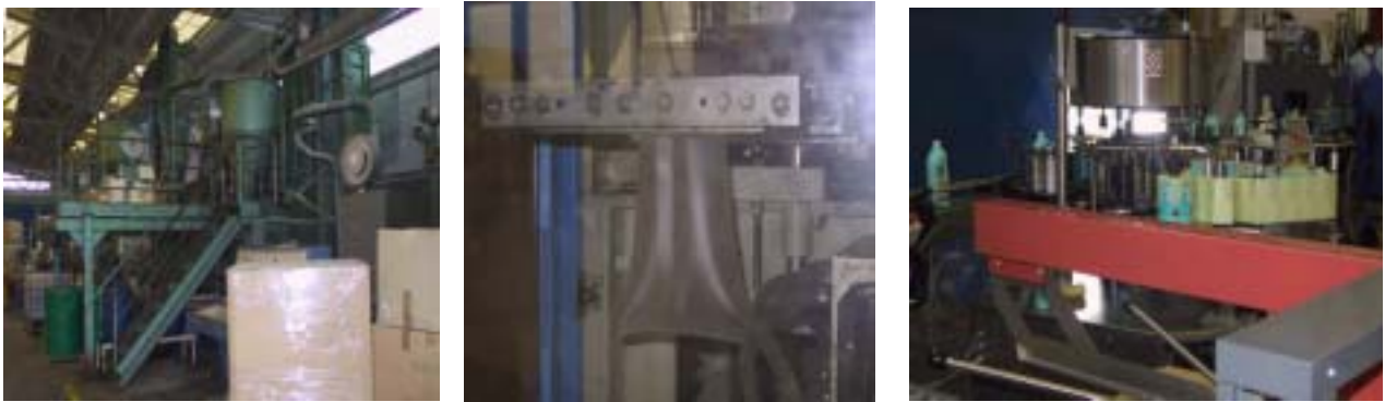
Abbildung 4: Detergenzienerzeugung; Mischanlage, Extruder zur Herstellung der Flaschen, Abfüllanlage
