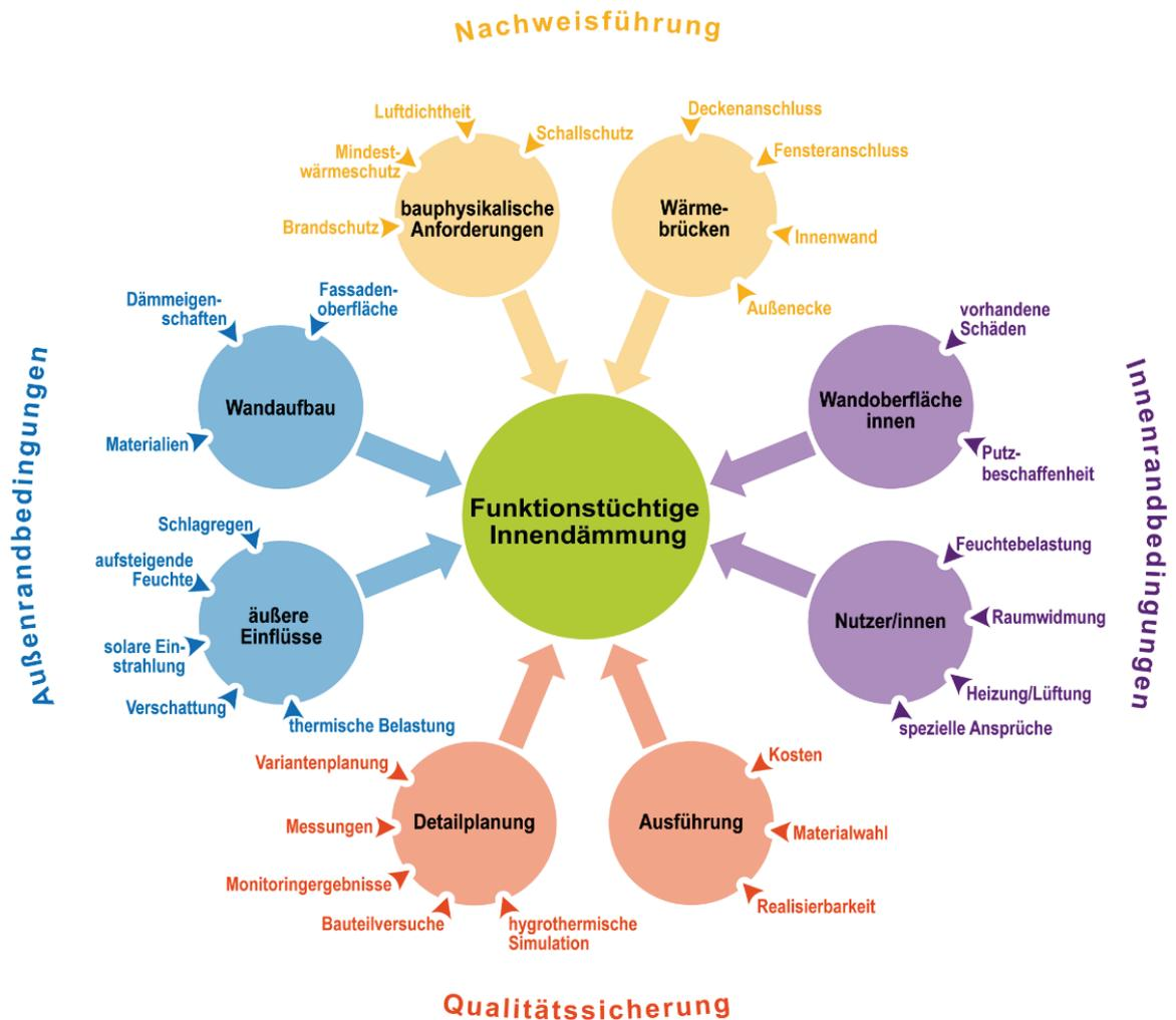
**Abb. 3: Einflussfaktoren für die Planung einer Innendämmung**
