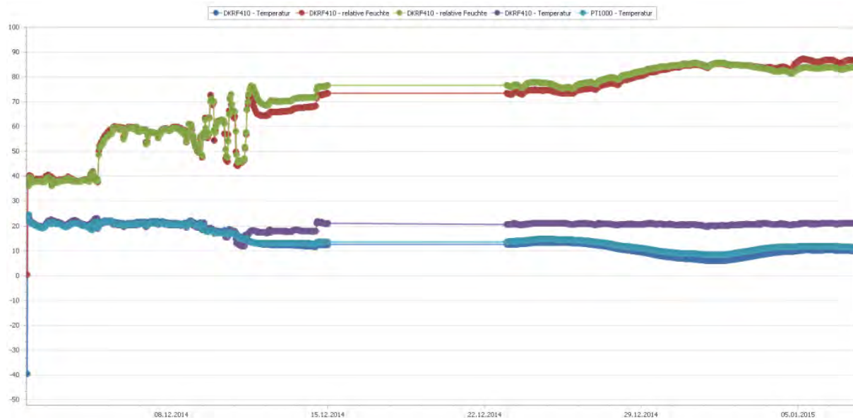
Abbildung 27: Ausfall Mess-System für 1 Woche, da der Trockenbauer bei der Applikation des Innendämmsystems die Sensoren vom Mess-System getrennt hat, um besser hantieren zu können.
