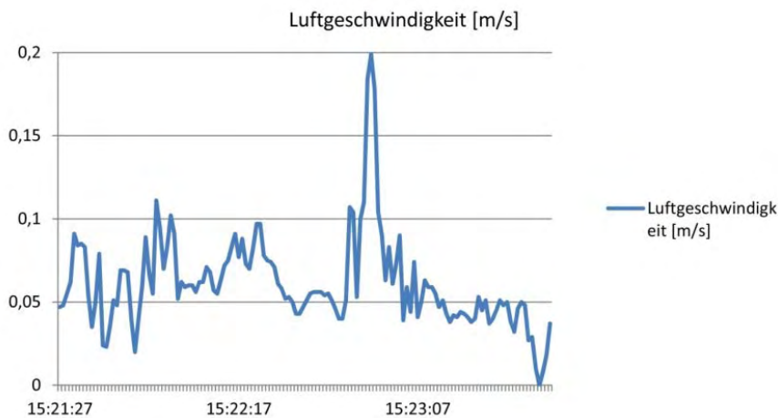
Abbildung 20: Messung Luftgeschwindigkeit [m/s], Sensor Swema 03+, Swema ISO 7730 Mess-System
