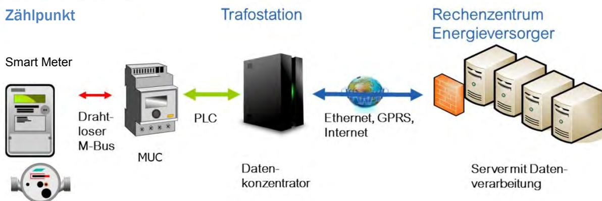
Abbildung 32: Systemübersicht Rollout-Szenario CH-2
