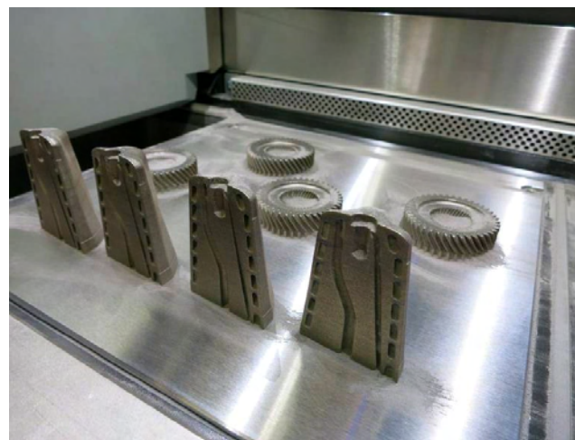
Halterung Airbus 380 (Quelle: EOS/EADS) Ausscheidungsgeh. rostfreier Stahl 17-4PH
