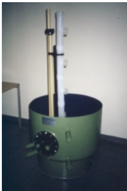
Abb. 13: Speicher mit SOLVIS Schichtladesystem (PINK)
