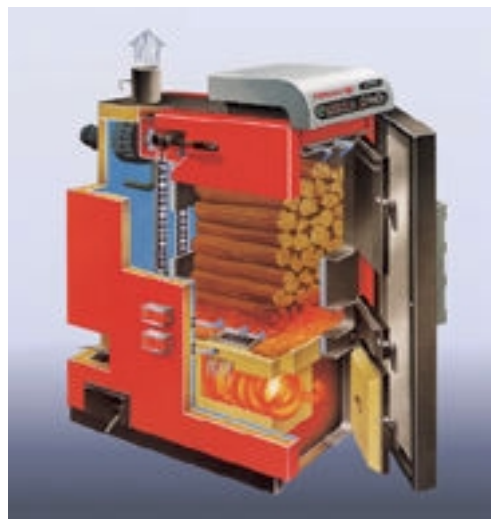
Abb. 3: Schema eines Scheitholz-Holzvergaserkessels
