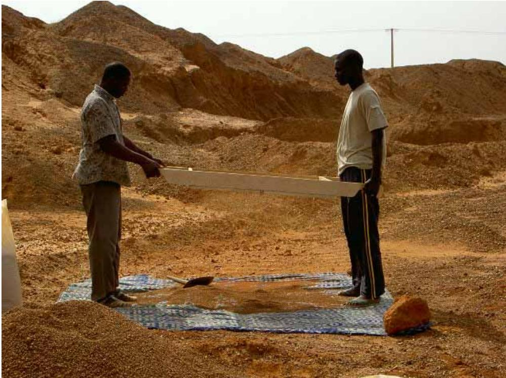
Abb. 32: Sieben des Luftporenbildners („Laterit“). Links im Bild Khadim Ndiaye. (J.-P. Uwiduhaye)
