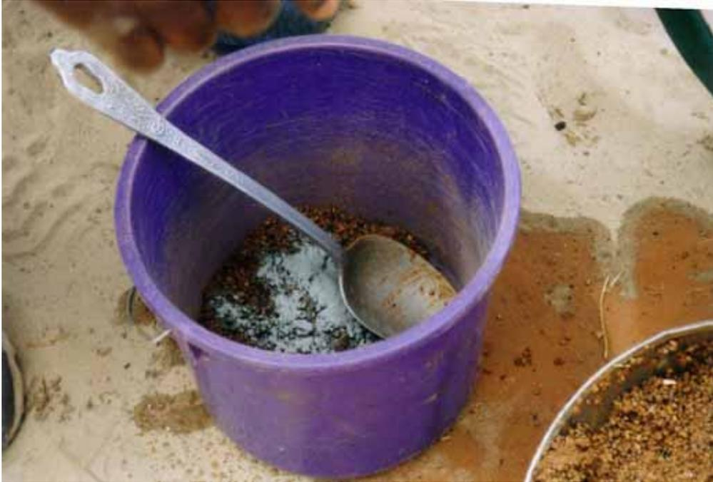
Abb. 33: Herstellung des SPS mit Luftporenbildner. (J.-P. Uwiduhaye)
