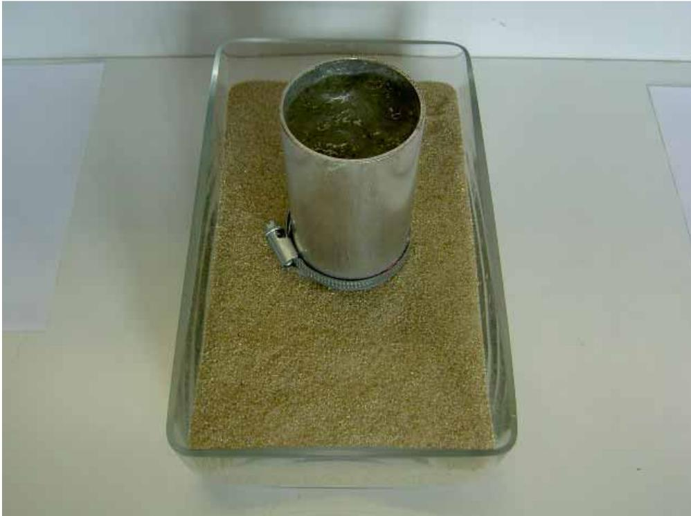
Abb. 5: Zylinder mit wassergesättigtem SP auf Sandboden
