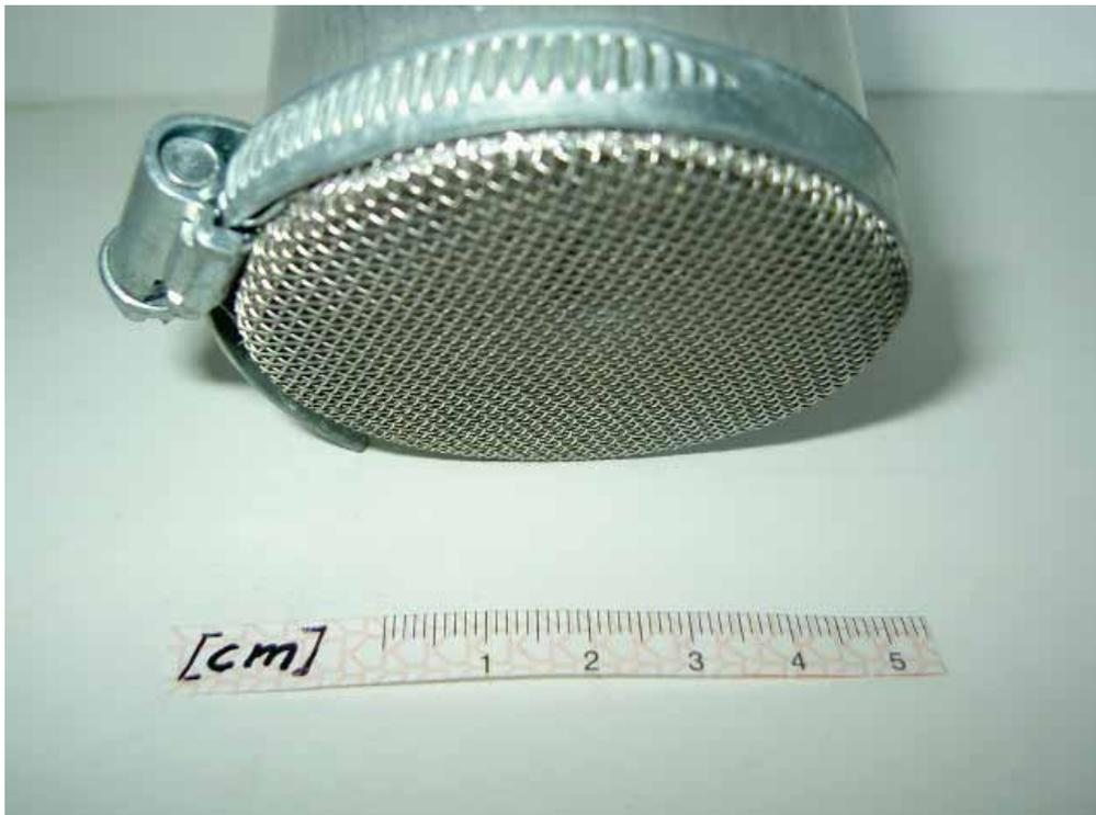
Abb. 4: Zylinder mit Bodensieb zur Bestimmung der Wasserspeicherung
