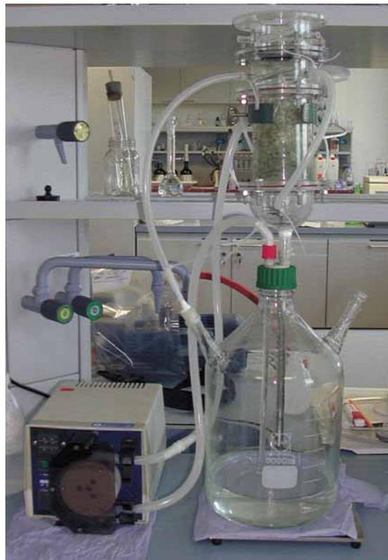
**Abbildung 10: Versuchsaufbau für den Auswaschtest**
