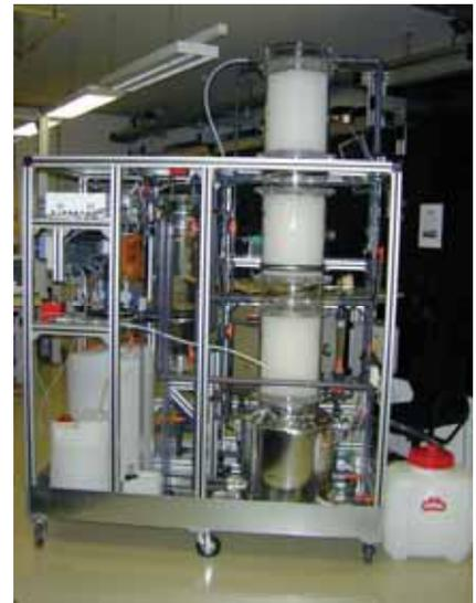
**Abbildung 1:** Fließbild der 3-stufigen Biotropfkörperanlage zur  $H_2S$ -Reinigung von Biogas nach Profactor
