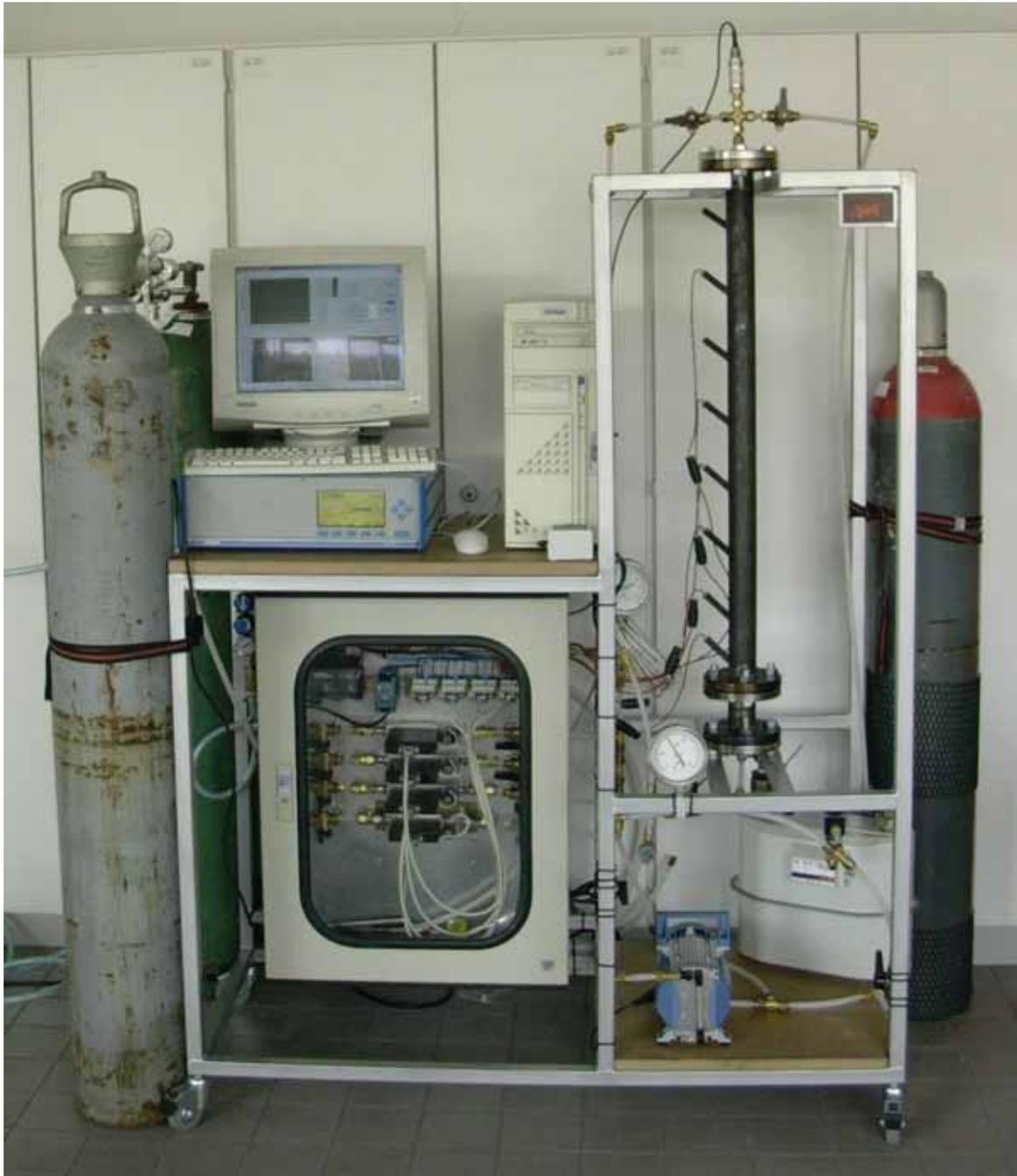
**Abbildung 23: Zur Untersuchung der Druckwechseladsorption aufgebaute Versuchsanlage**
