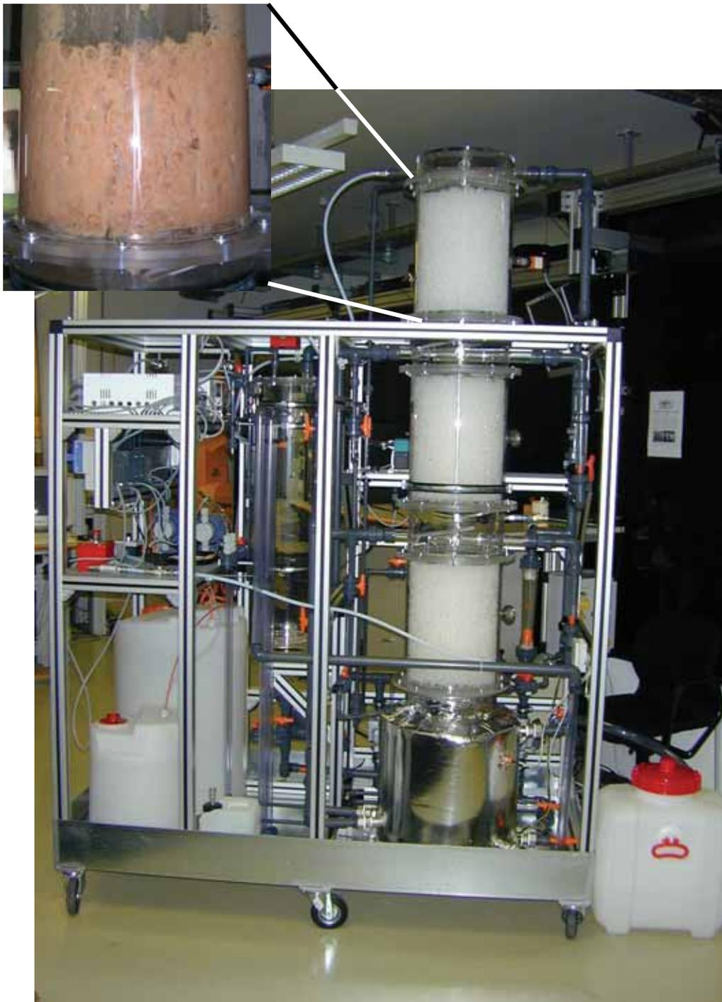
Abbildung 13: Foto der 3-stufige Biotropfkörperanlage zur H<sub>2</sub>S-Reinigung von 1m<sup>3</sup>/h Biogas vor der Inbetriebnahme. Detail: Bewuchs auf Füllkörper während der Testreihen
