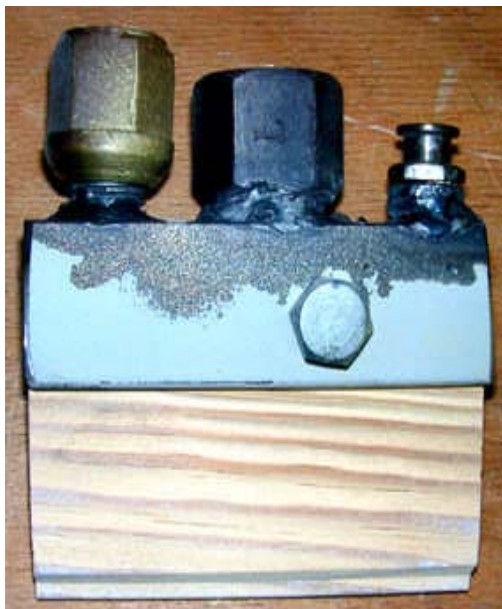
Abb. 71: Strahlversuch mit zerkleinerten Kirschkernen (Durchmesser 0,5 – 1 mm)
