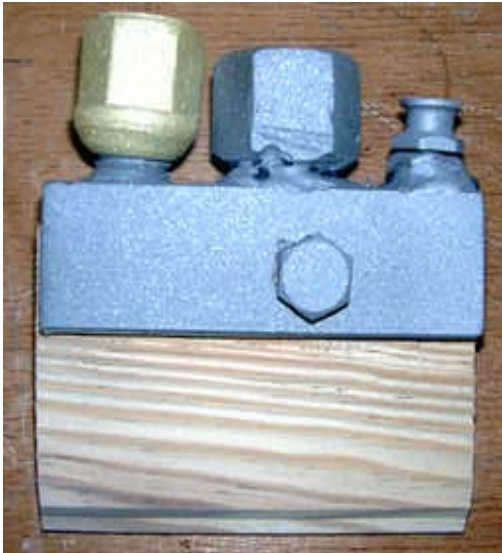
Abb. 72: Strahlversuch Normalkorund (Durchmesser 0,5 – 1 mm)
