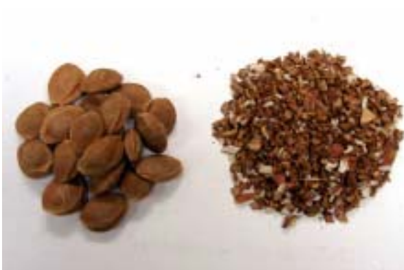
Abb. 7: Ergebnis des Brechversuches mit einer Walzenmühle
