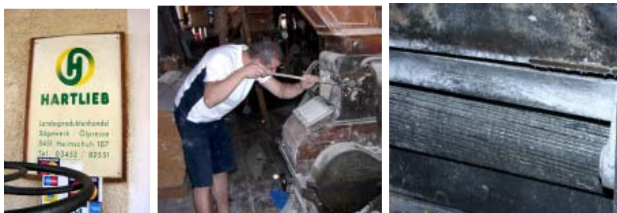
Abb. 9: Walzenstuhl-Einlass u. Riffelwalzen, Ölmühle HARTLIEB in Heimschuh (Südmk.)
