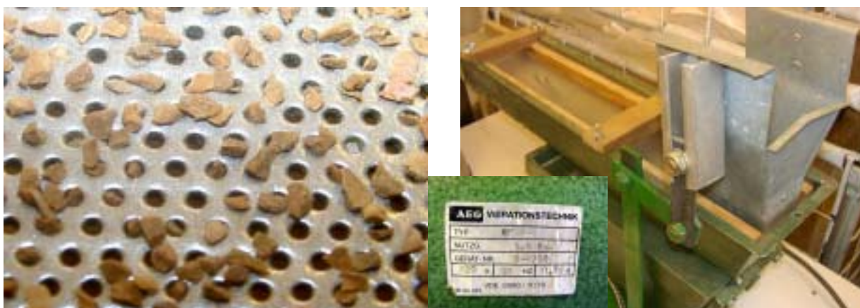
Abb. 14: Fraktionierung harter Kernschalen über Lochsiebe, Vibrationsgerät
