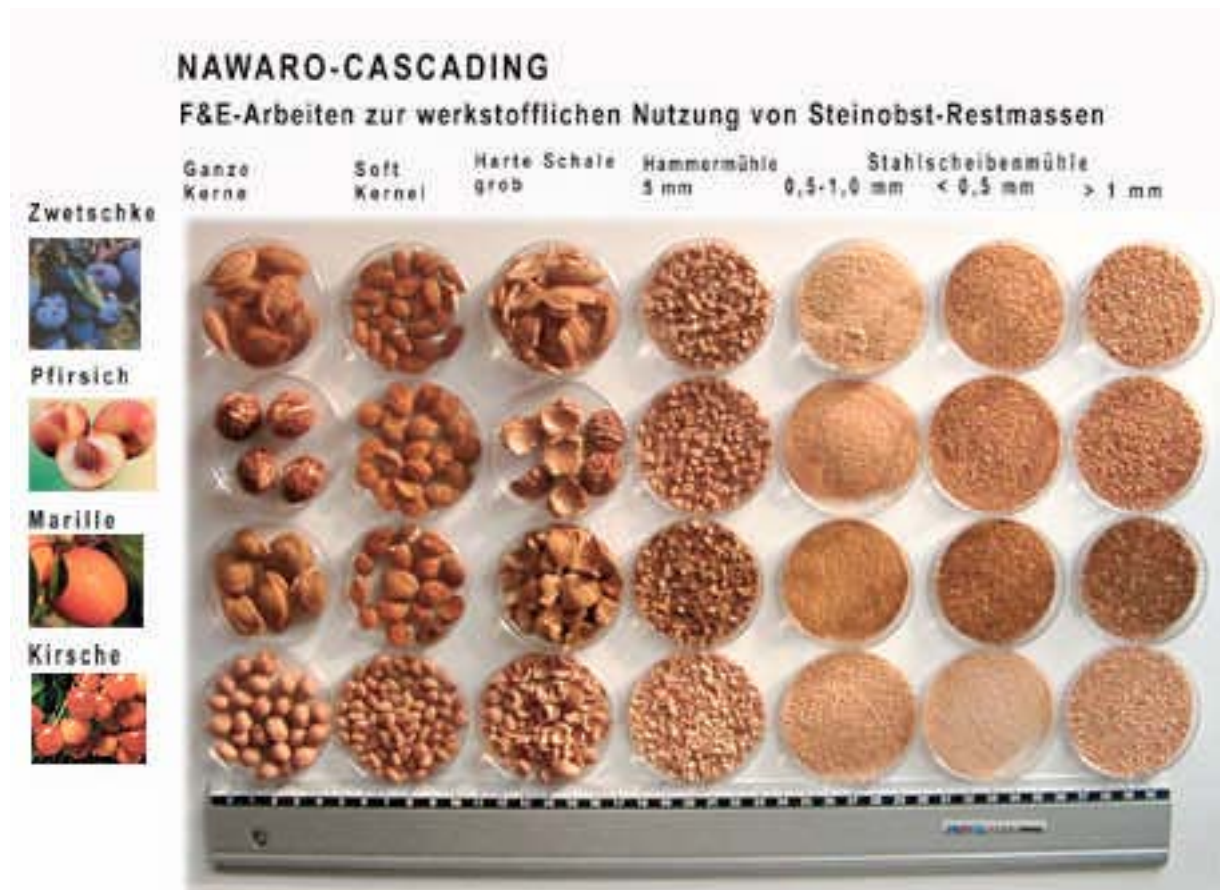
Abb. 67: alle Fraktionen nach der Zerkleinerung und Siebung
