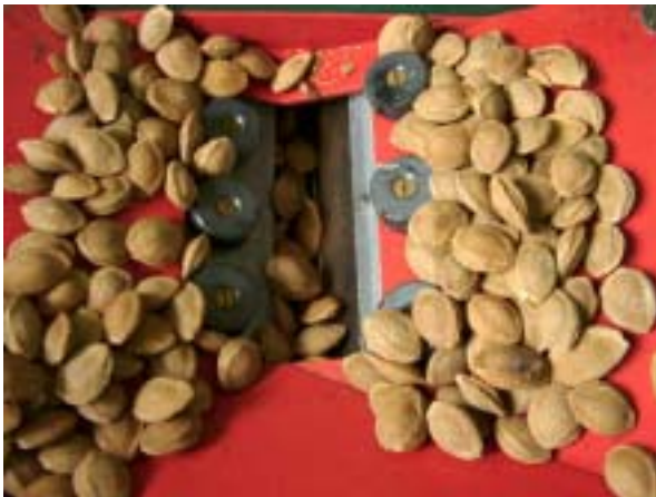
Abb. 6: Brechversuch mit Marillenkernen in einer Walzenmühle
