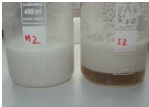
Abb. 55: Testpräparate mit 10% Kernmehl von Mandel bzw. Sonnenblume 3 Stunden nach Anfertigung
