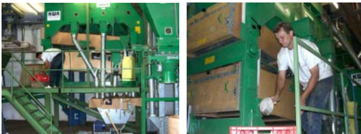
Abb. 10: Grassamentrennlage der PSO, H. Buchgraber entfremdet die Anlage zum Trennen von Pfirsichkernen
