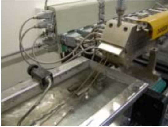
Abb. 73: Extruderdüse mit austretender Polymerschmelze und hergestellte Mischung in Granulatform
