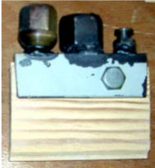
Abb. 70: Strahlversuch mit zerkleinerten Kirschkernen (Durchmesser 0,5 – 1 mm)
