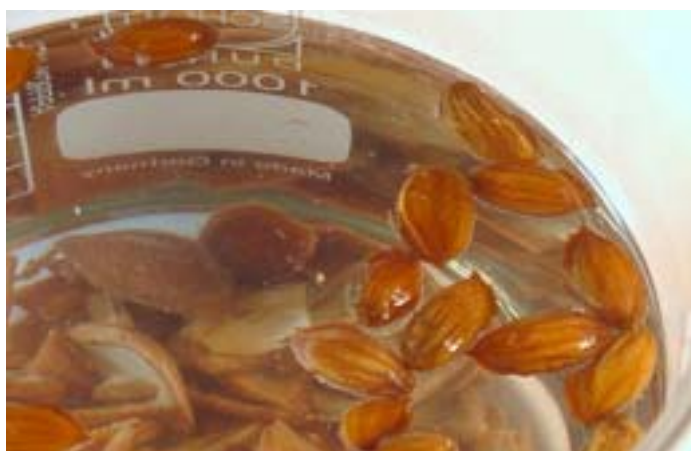
Abb. 8: Schwimm-Sinkversuch mit harten Schalen und weichen Obstkernen
