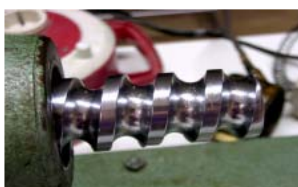
Abb. 21: Schneckenpresse vom Typ „Komet“, freundlicherweise beigelegt v. Bio-Ölmüller H.J. Schumann, O.Ö.
