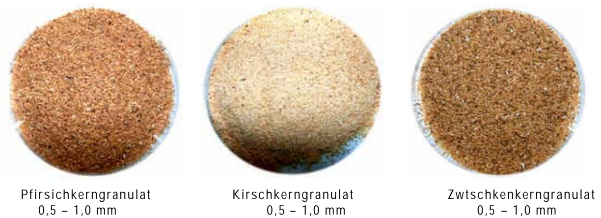
Abb. 68: ausgewählte Fraktionen für Strahlversuche bei der Fa. RAGA
