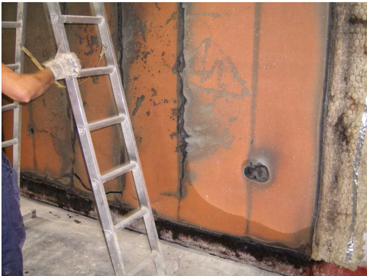
(Foto 3, Innenseite der Wand nach Ende des Brandtests; der Lehm ist zu Keramik gebrannt)
