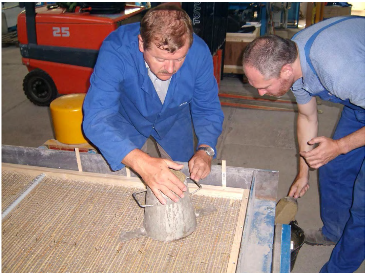
Foto 9: Beginn eines Ausbreitversuchs am Schwingtisch mit Gemengekonsistenz „Kegel“.
