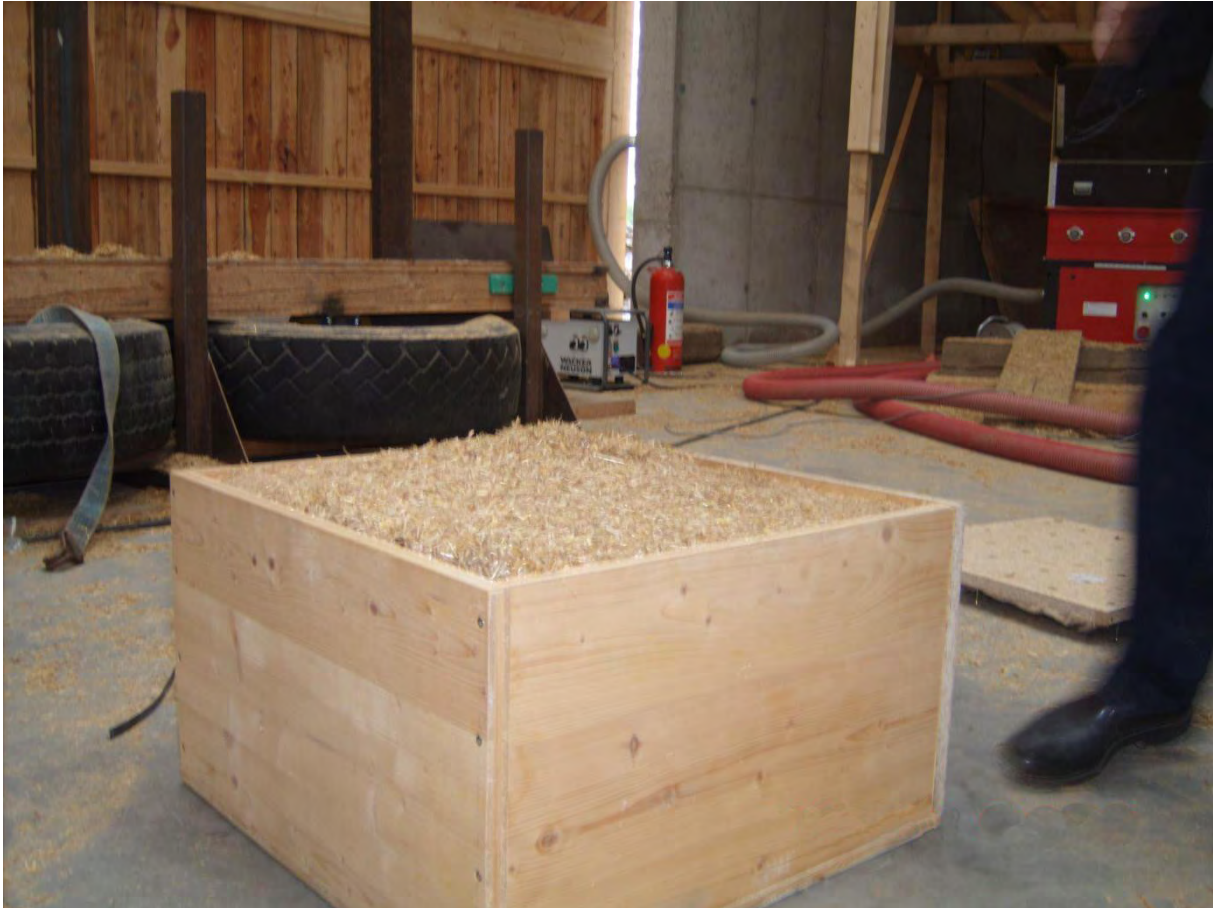
(Foto 7: Kontrolle des Füllungsgrades nach Öffnen des Probekörpers.)
