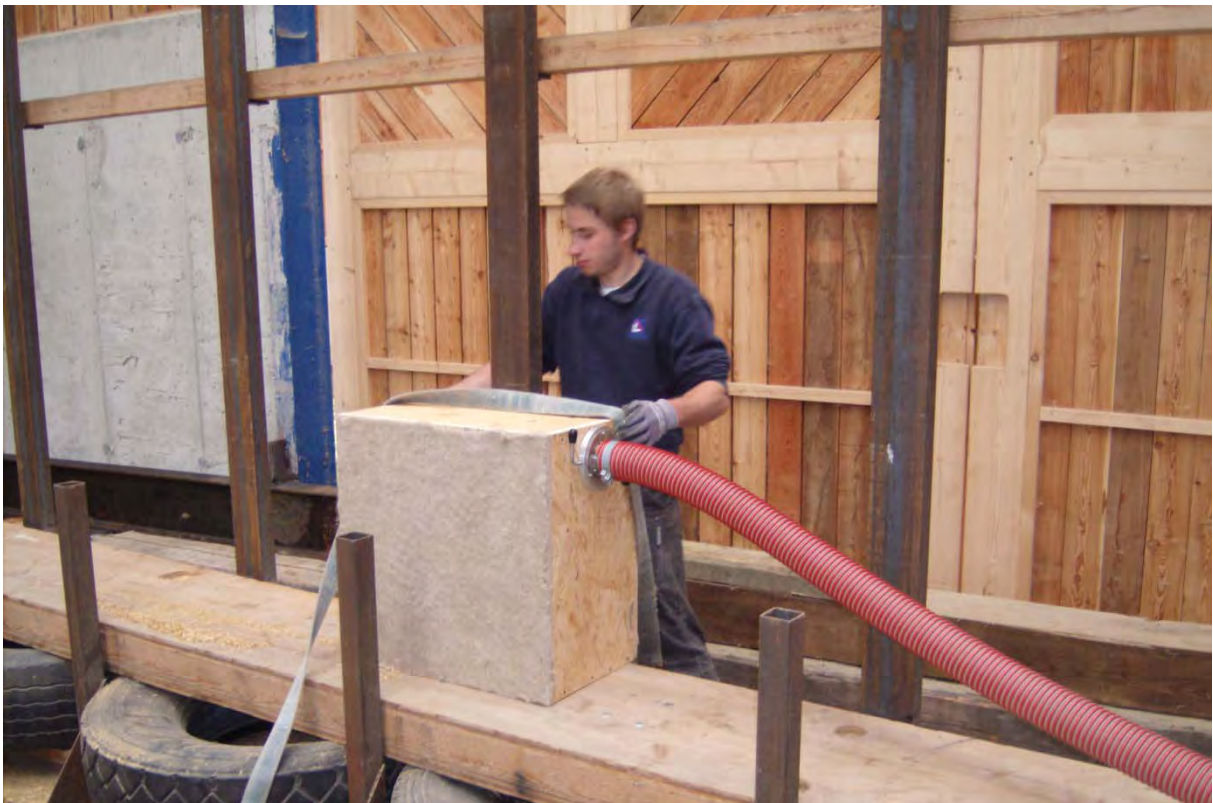
(Foto 6: Befüllung des Prüfkörpers mit Strohhacksel)
