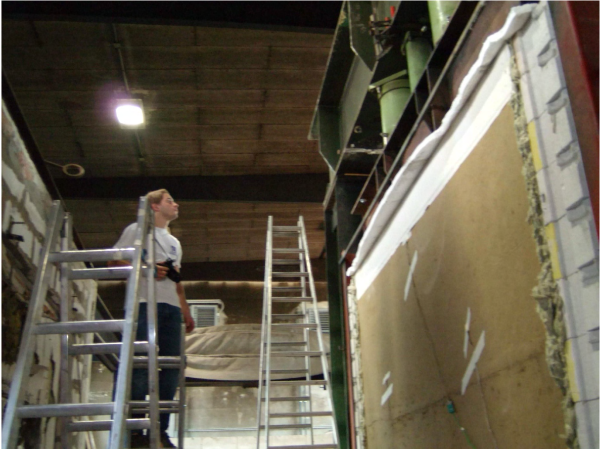
(Foto 1: Die Außenseite des in die Brennkammer eingebauten Testmodells mit den Temperaturfühlern (mit weißen Klebstreifen befestigt)
