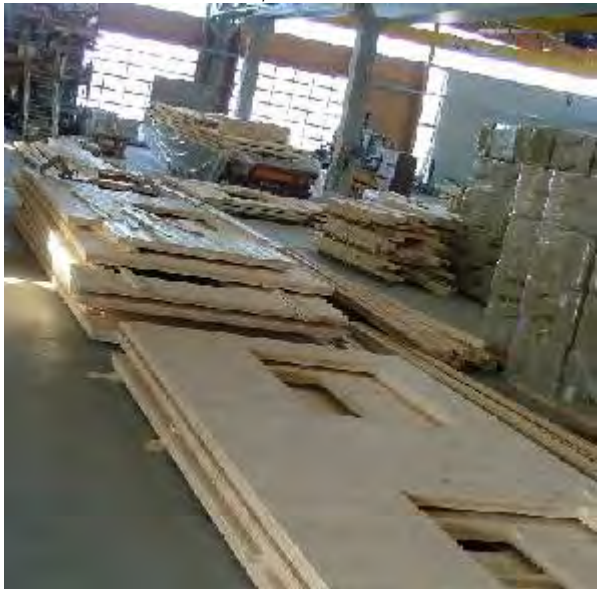
Fassadenfertigteile: KLH- Massivholzplatten
