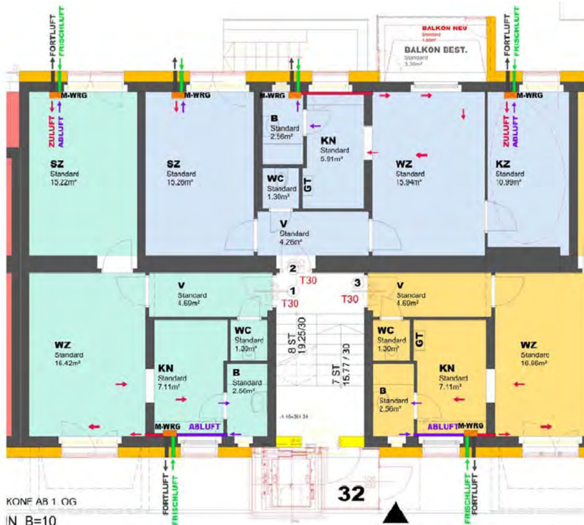
Abbildung 5 Darstellung des Einzelwohnraumlüftungssystems für drei unterschiedliche Wohnungstypen [Domenig - Meisinger I. et. al.]
