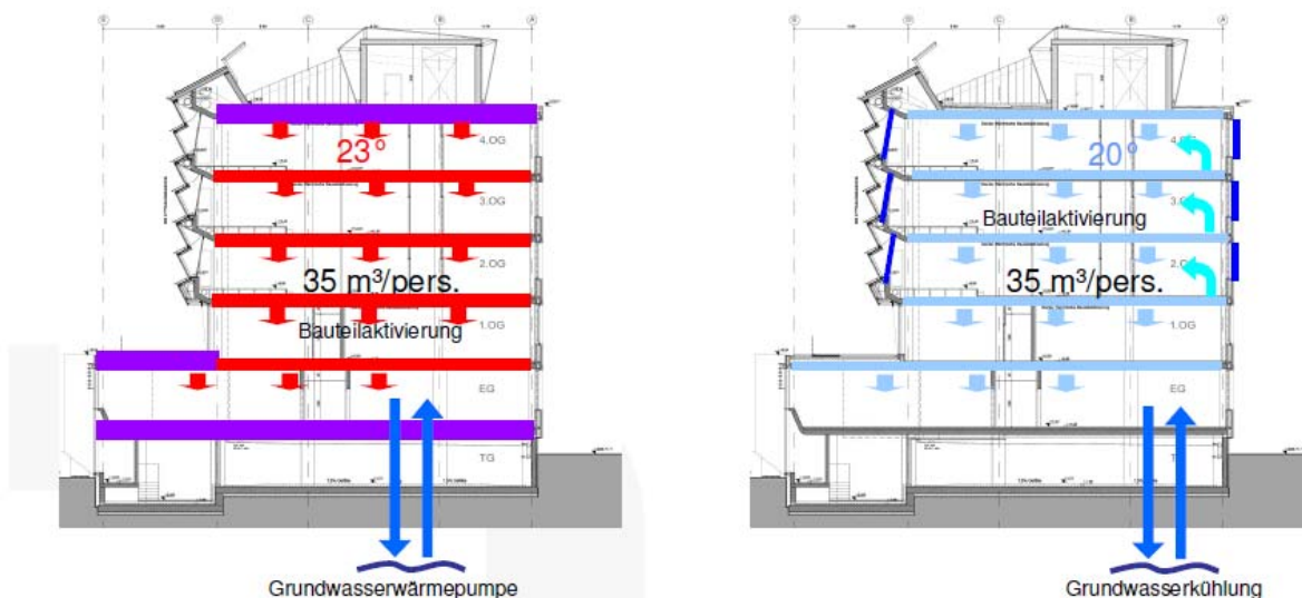
Abbildung 4 Schematische Darstellung Heizung Kühlung c. pos-architekten
