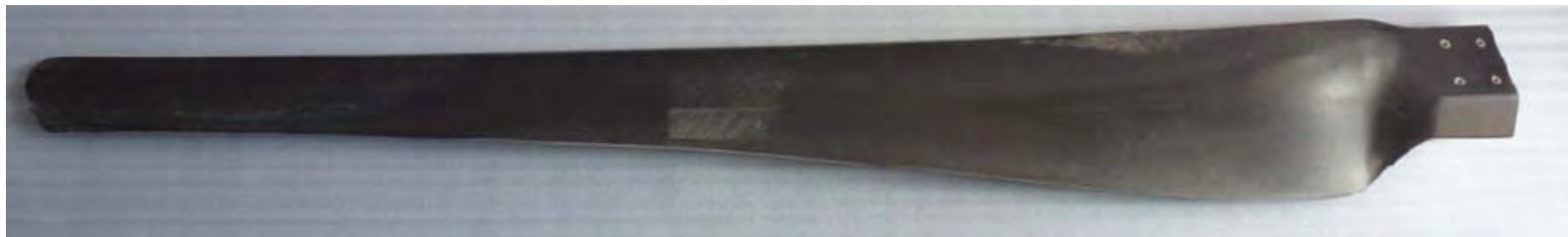
2 m lange Rotorblätter für Kleinwindkraftanlagen aus Hanf-Leichtbauwerkstoff
