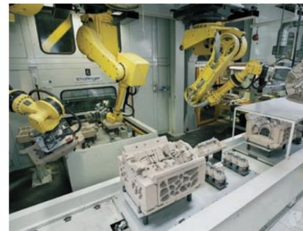
Vollautomatische Kernherstellung und -montage setzt Maßstäb
