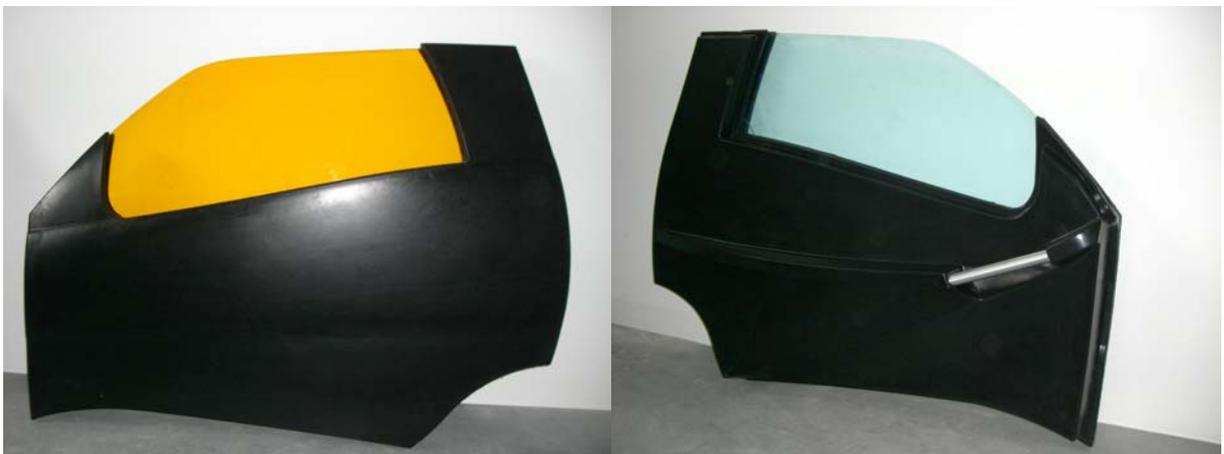
Abbildung 11: Fahrzeugtür aus Polypropylensandwichteilen – hergestellt mit der Pilotanlage
