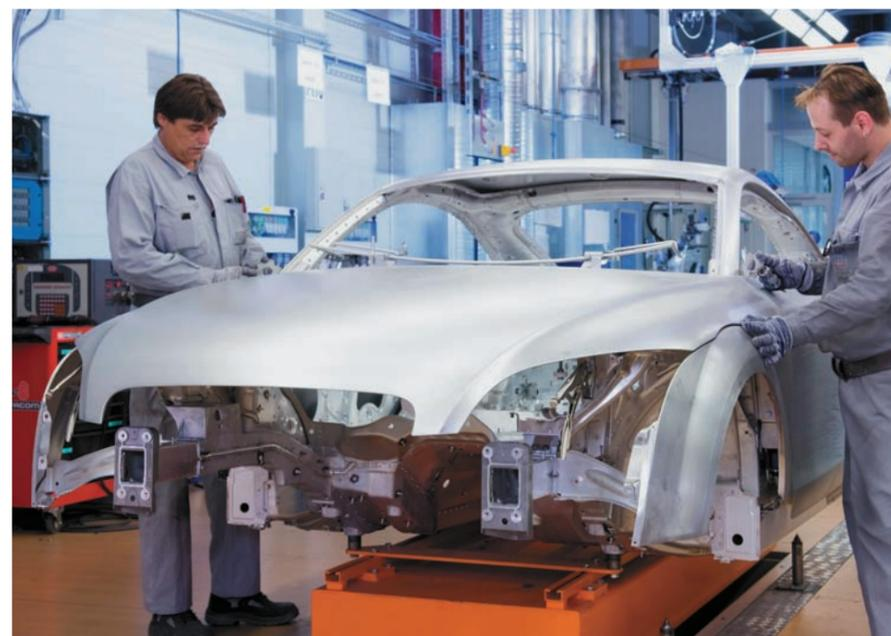
Aluminium-Pionier Audi schuf für die zweite Generation des Sportwagens TT eine Leichtbau-Karosserie in Mischbauweise.
