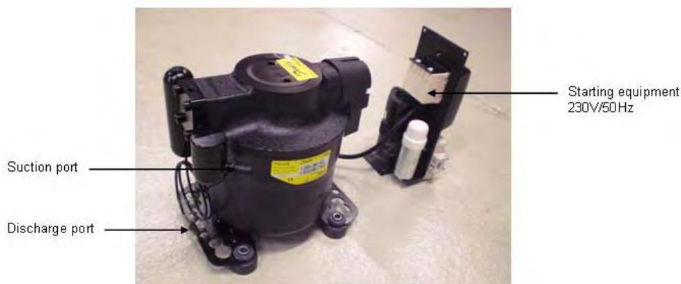
Abbildung 6.12: Kompressor Danfoss TN1416 vor dem Einbau in die Versuchsanlage
