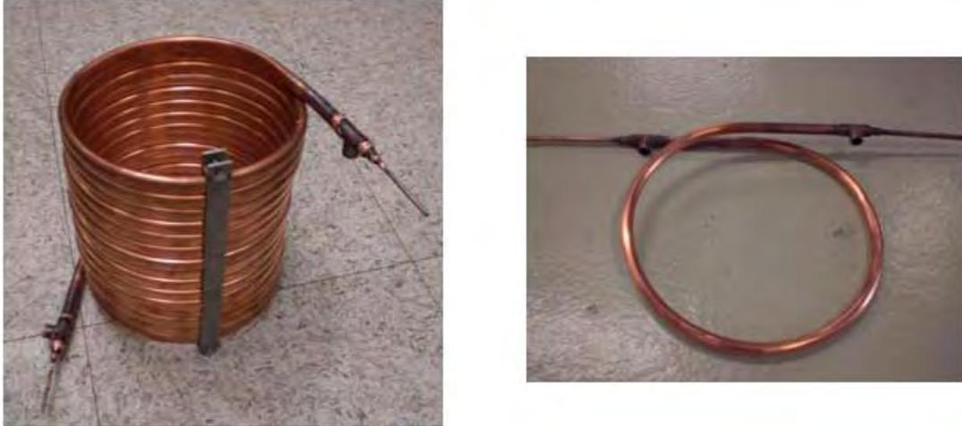
Abbildung 6.13: Gaskühler 1 (links) und Gaskühler 2 (rechts) vor dem Einbau in die Versuchsanlage
