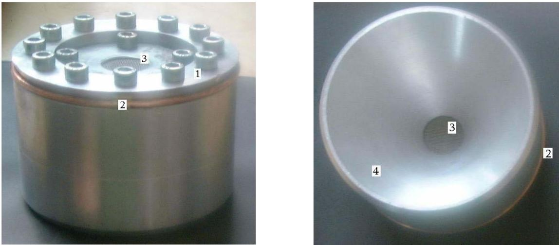
Abbildung 3-23: Düsenboden mit Kupferdichtung und Metallfilter
