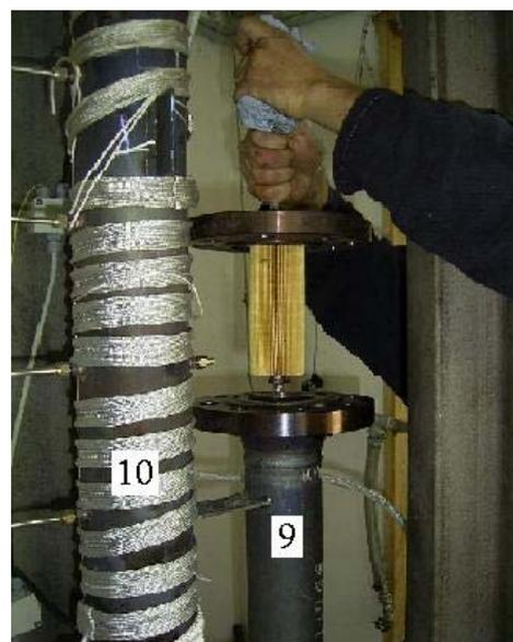
Abbildung 3-24: Partikelfilter für Katalysator und FT-Produkt-Auslass
