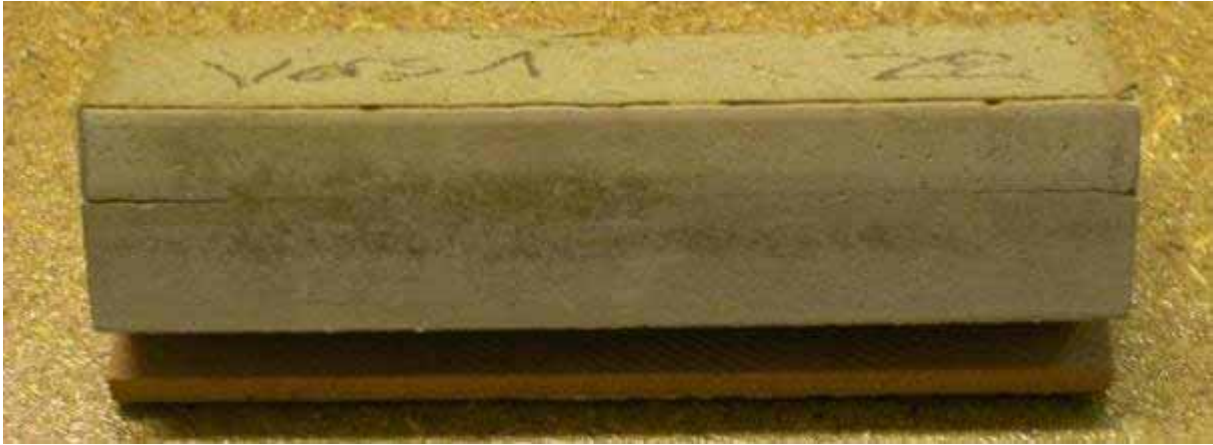
Abbildung 64: Prismenprüfkörper des Versuchs 1 (Grasfaser anstatt Methylcellulose)
