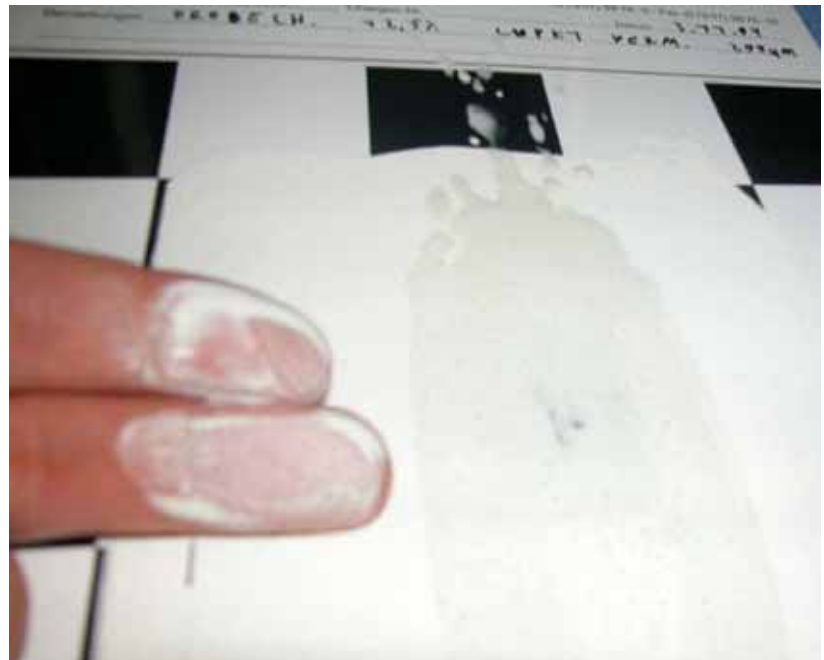
Abbildung 73: Schwierigkeiten bei der Applikation der Farbe mit Grasfaserfüllstoff
