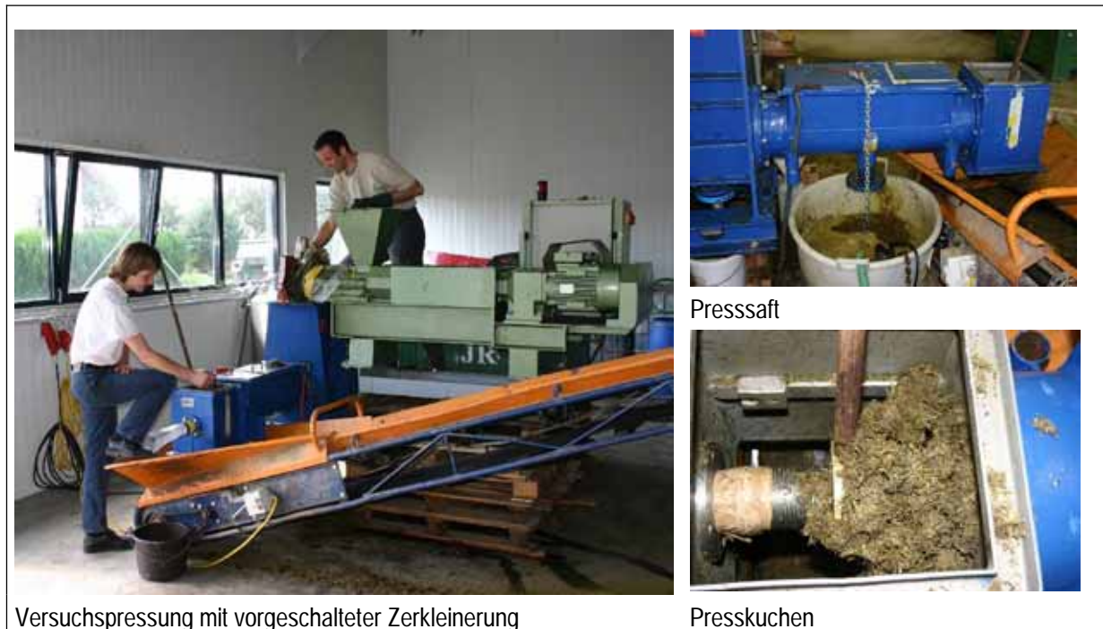
Abbildung 9: Durchführung eines Abpressversuches
