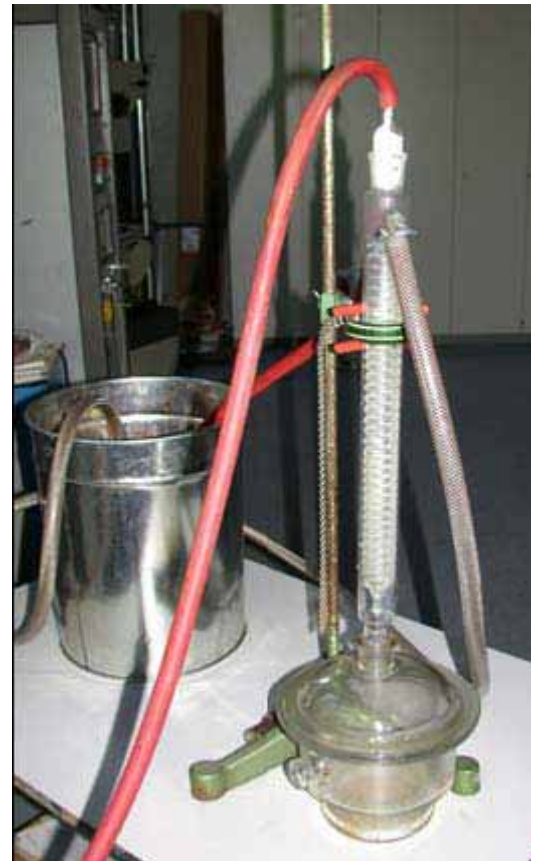
l. o...Autoklav mit Steuerung l. u. Reaktionsraum ca. 1 Liter r. o Kühlung für Kondensat
