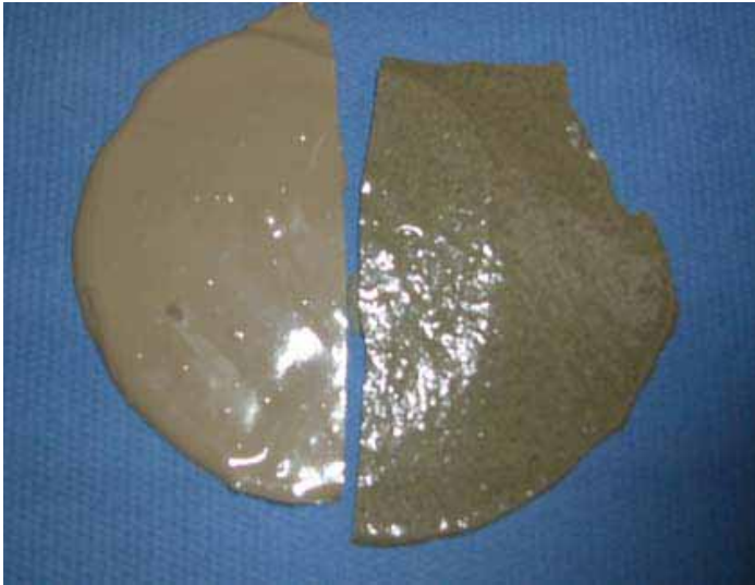
Abbildung 62: Vergleich Parkettkleber; links Originalrezeptur, rechts mit gemahlener Grasfasern
