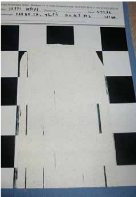
Abbildung 72: Deckkraft-Tests: Wandfarbe mit modifizierten Grasfasern als Füllstoff
