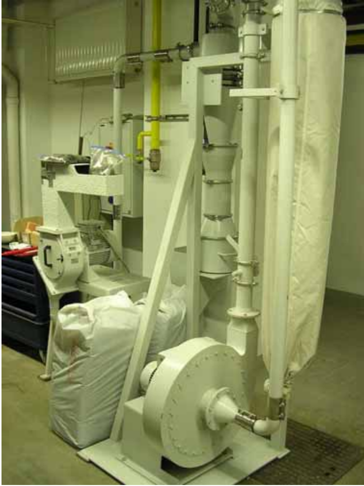
Abbildung 21: Labormühle mit Gebälse, Institut für Verfahrenstechnik TU Wien
