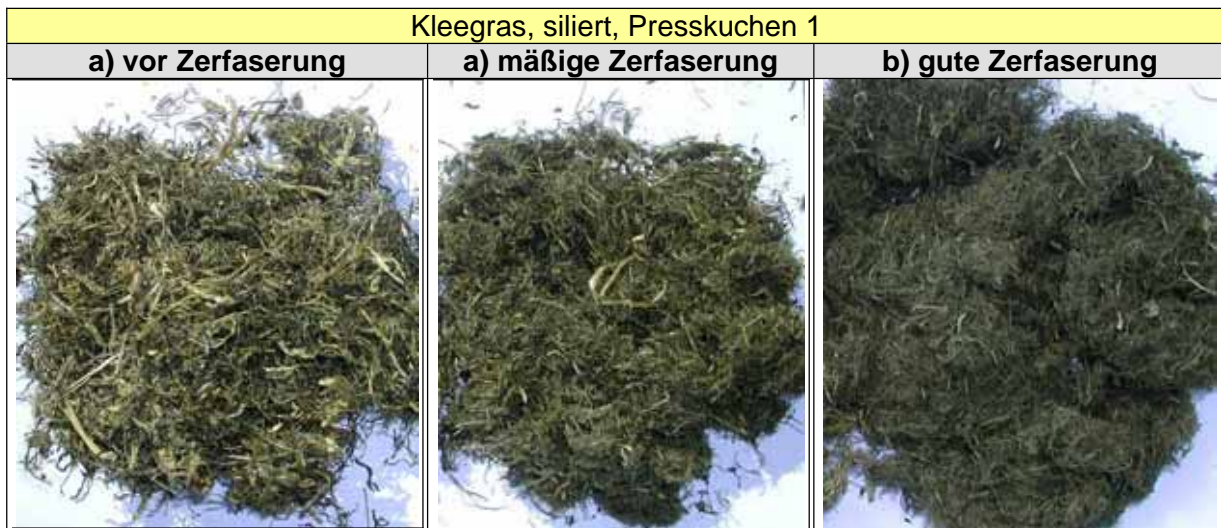
Abbildung 19: Wirkung der TMZ - Zerfaserung am Beispiel Kleegras Presskuchen 1
