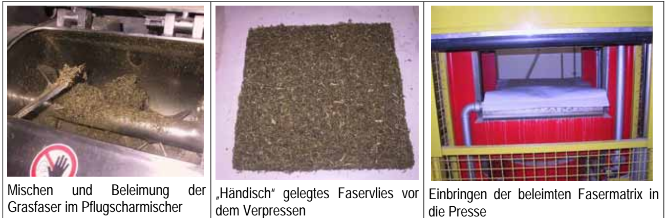
Abbildung 45: Arbeitsschritte der Herstellung der Grasfaserversuchsplatten
