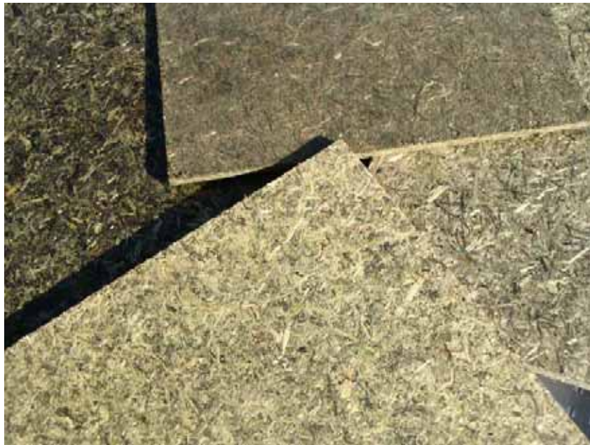
Abbildung 46: Grasfaserplatten aus verschiedenen Faserfraktionen
