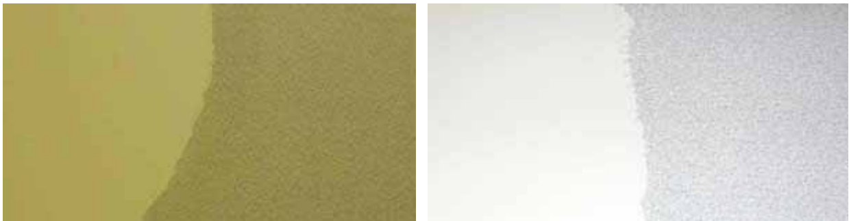
Abbildung 66: Beschichtungssystem auf Epoxidharz-Basis; Grasfaser als „optischer Effekt“; linke Bildhälfte ohne, rechts mit Grasfaser Beimengung
