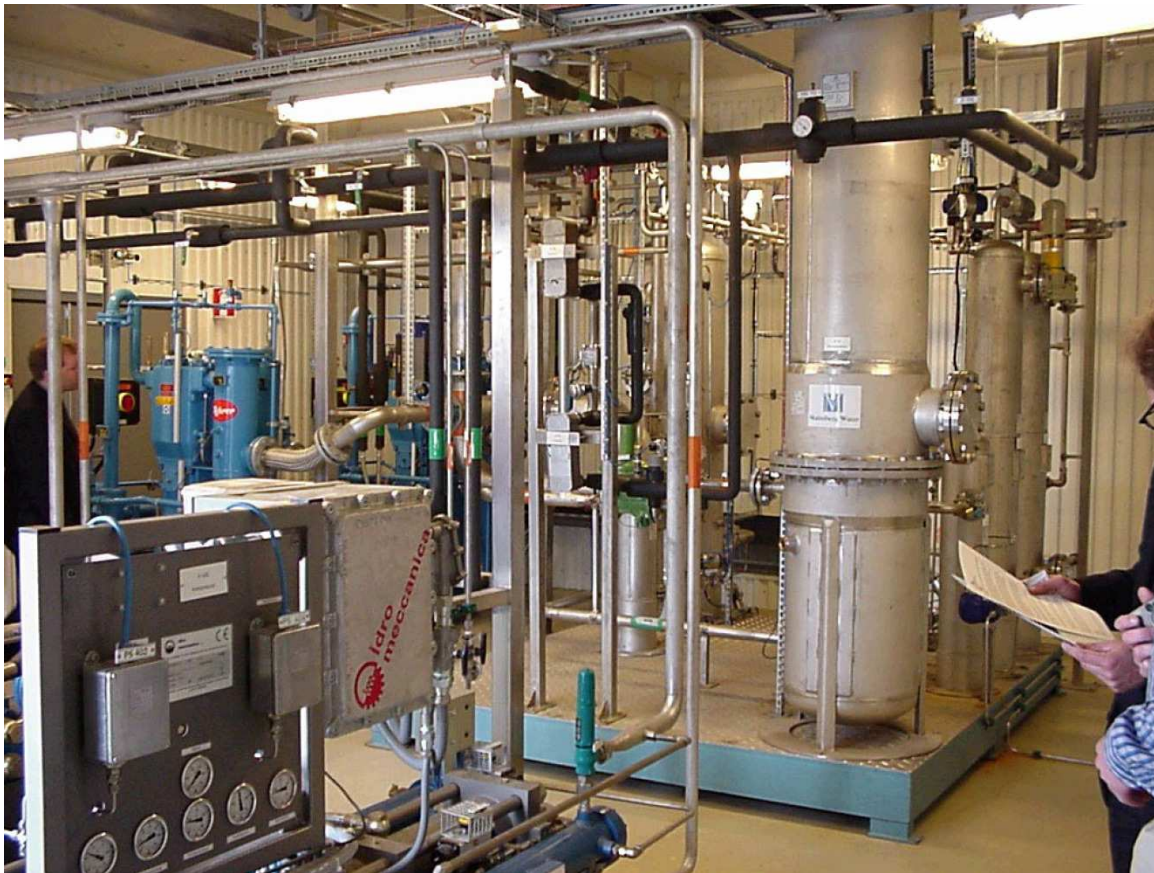
Abbildung 73: Anlage zur Aufbereitung von Biogas mittels der Druckwasserwäsche [Nilsson et.al 2001]
