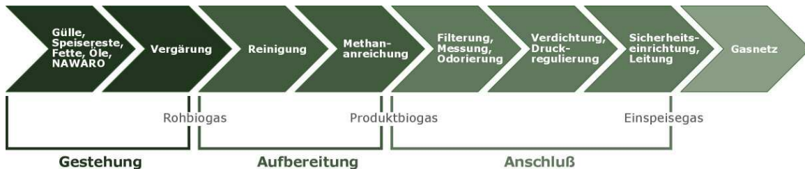
Abbildung 1: Verfahrensschritte bei der Biogas-Netzeinspeisung
