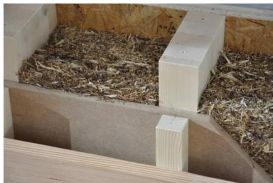
Die produzierten Dämmstoffplatten weisen Wärmeleitfähigkeitswerte von 0,043 bis 0,070 W/(m\*K) im Rohdichtebereich von 80 bis 300 kg/m<sup>3</sup> und lassen sich leicht verarbeiten. Mit diesem Projekt wurden Grundlagen für eine breite Anwendbarkeit des Strohmaterials für Dämmstoffe geschaffen.
