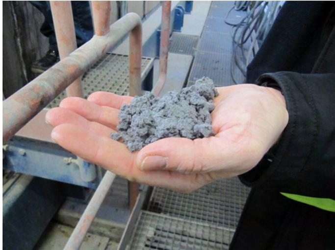
Abbildung 2.6: Entwässerter Klärschlamm aus der Altpapierrecyclinganlage
