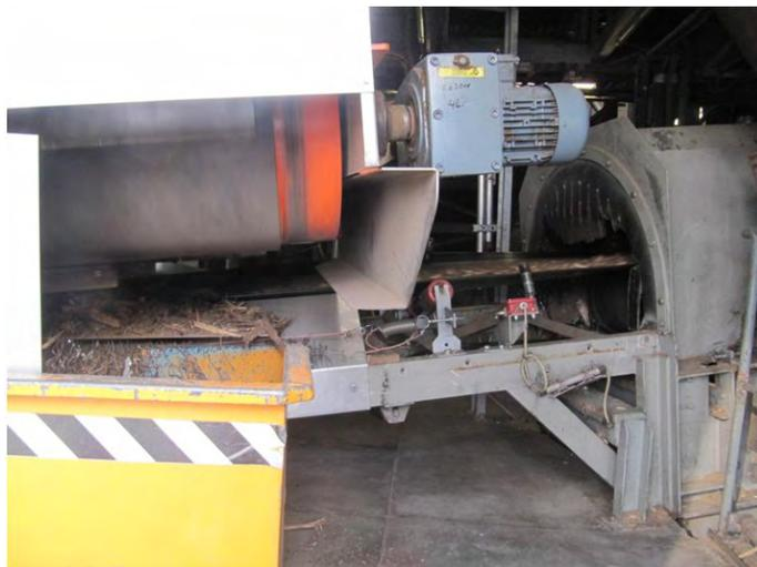
Abbildung 2.23: Eisenabscheider der Brennstoffaufbereitungsanlage der Biomasseanlage Timelkam
