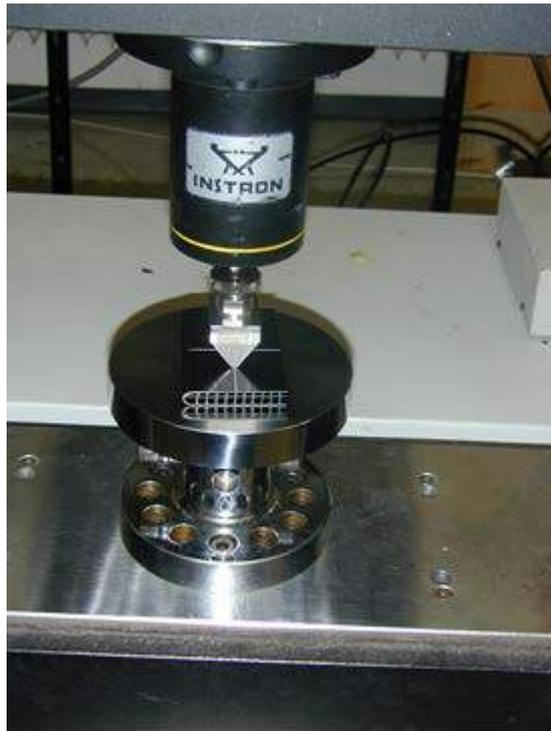
**Abb. 6:** Indentationsapparatur für die Prüfung von Bauteilsegmenten aus Kunststoffabsorbieren (Kahlen et al., 2010b)
