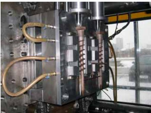
Mit der in einer Spritzgussmaschine eingebauten zweifachen Spritzgussform kann pro Minute eine Schraube produziert werden.
