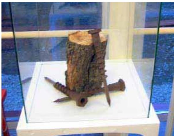
Ausstellung der Treeplast Schraube die zur Fixierung der Verschalung auf den Strohballen benutzt wurde, .
