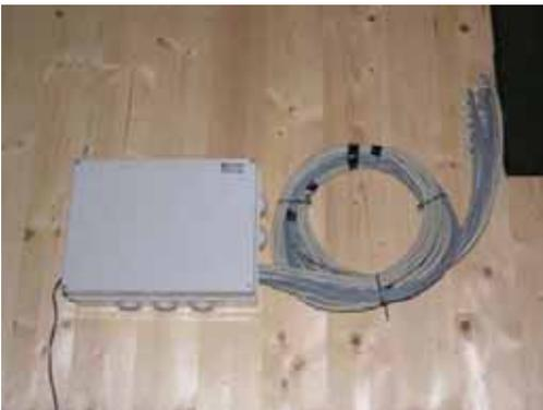
In den Boxen zeichnen Wärmestromplatten, Feuchte- und Temperaturfühler die Messwerte der Dämmstoffe auf.
