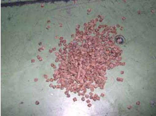
Das Granulat für die Befestigungsschrauben besteht zu 100% aus nachwachsenden Rohstoffen.
