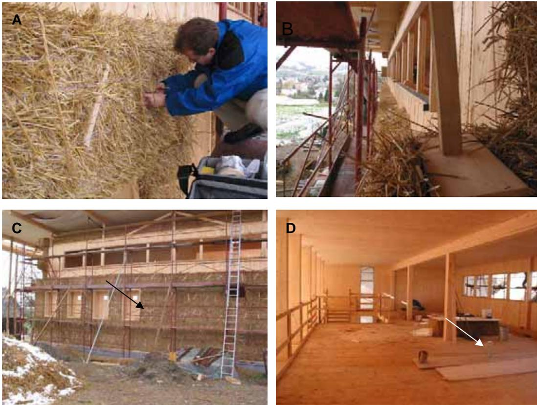
Abbildung 36: Probenahme am 25.10.2004; (A) Entnahme von Stroh mit steriler Schere, (B) Entlang der Nordfassade wurden 4 Proben entnommen, (C) Entnahmestelle am Messfühler für Probe Nr.7 Nord, (D) Luftkeimsammlung mit dem Sartorius MD8 im noch offenen Innenraum.
