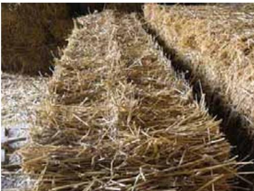
Der Boden wird, wie die gesamte S-HOUSE Gebäudehülle, mit Strohballen gedämmt.
