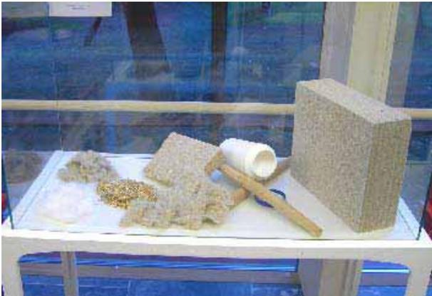
Rohstoffe zur Herstellung von Naturfaser Zwischenwänden.
