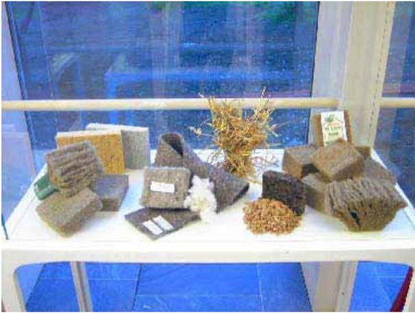
Dämmstoffe aus nachwachsenden Rohstoffen (Zellulose, Holzwolle, Flachs, Schafwolle, Stroh, Kork, Hanf).
