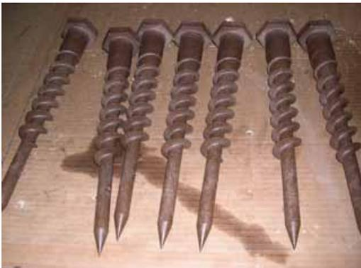
Fertige Muster der spritzgegossenen Schrauben zum Auskühlen aufgelegt. Nach dem Aushärten erfüllt der spritzgegossene Biokunststoff die gestellten technischen Anforderungen ohne, dass die ökologische Performance beeinträchtigt wird.
