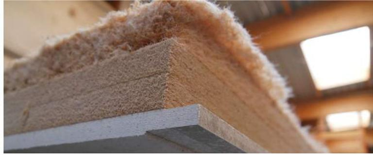
**Abb. 4: Demonstration Anpassung flexibler Schicht an unebene Bestandwand.**
